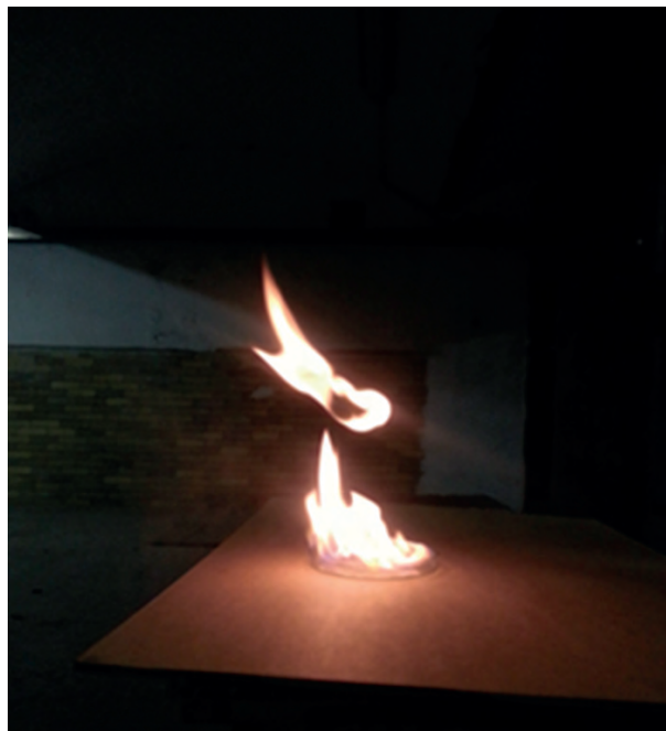
obr. 4 Výstřel z pistole v prostředí hořlavých par (foto autor)
