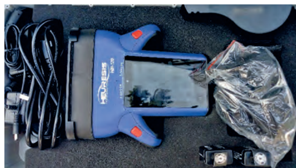
Obr. 2 – Ruční rentgenový zobrazovač s příslušenstvím (Zdroj: NPC SKPV PČR)
