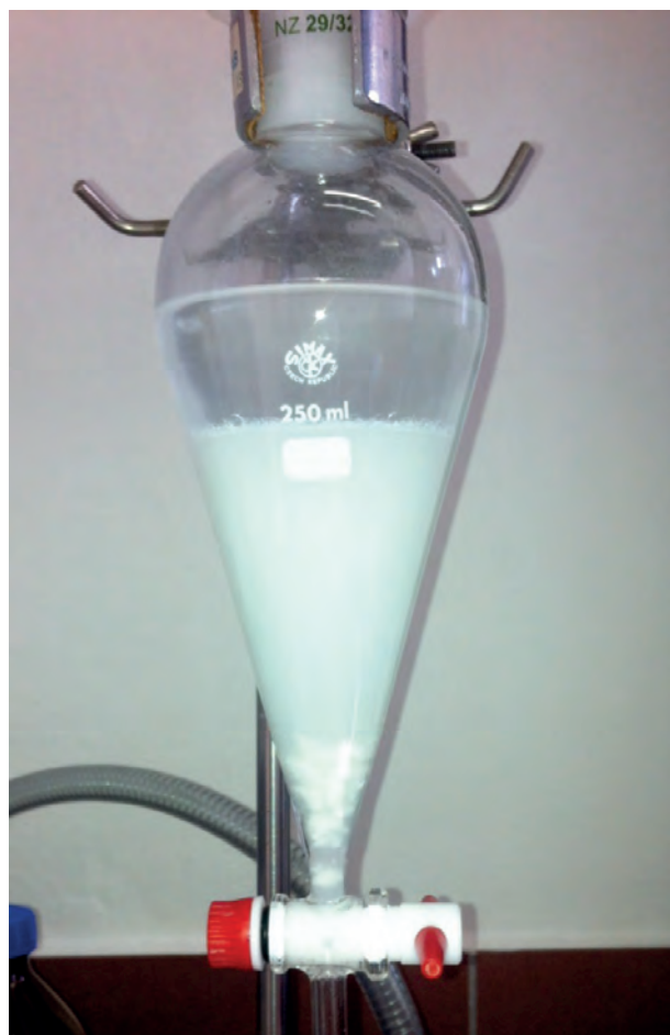
Obrázek 6: Roztok s nerozpuštěnými kousky tablet léčiva Cirrus po extrakci toluenem
