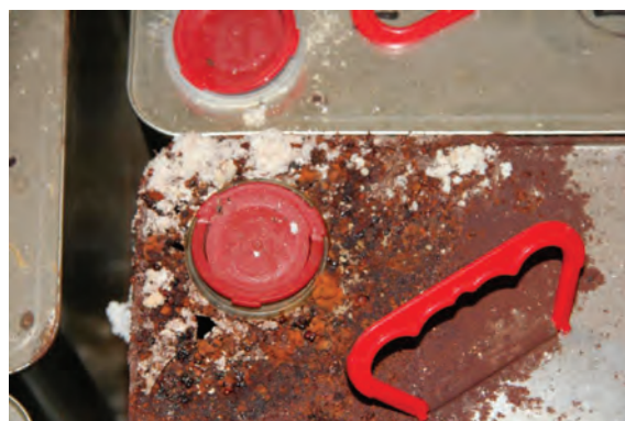
Obr. 4 – Účinky kyseliny chlorovodíkové na plechový kanistr – detail (Zdroj: Archiv autora)
