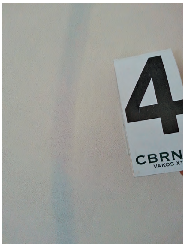
Obr. 1: Kontaminace z hadicového vedení zachycená ve zdivu – modrá barva negativní, fialová pozitivní (Zdroj: VAKOS XT)
