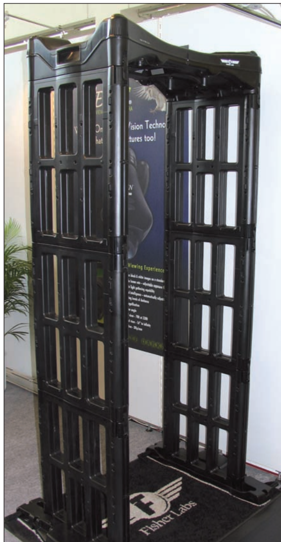
Texaská firma Fischer Labs vystavovala lehký skládací rám pro průchozí detekci kovových předmětů
