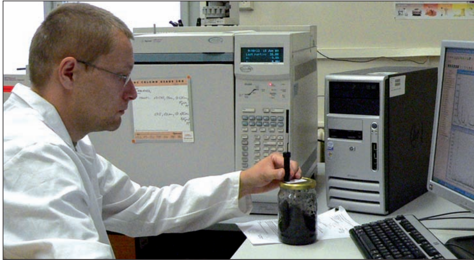
Kpt. Halamek v laboratoři pracuje s konzervou, ze které odebírá vzorek neshořelých a neodpařených hořlavín
