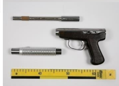
Podomácku vyrobená jednoranová pistole ráže 9 mm Luger
