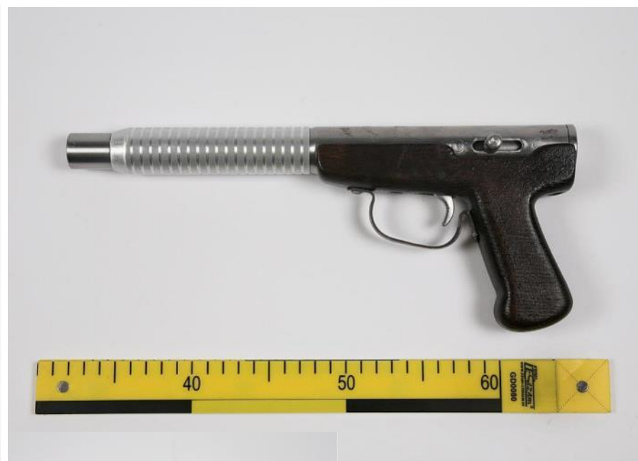
Podomácku vyrobená jednoranová pistole ráže 9 mm Luger
