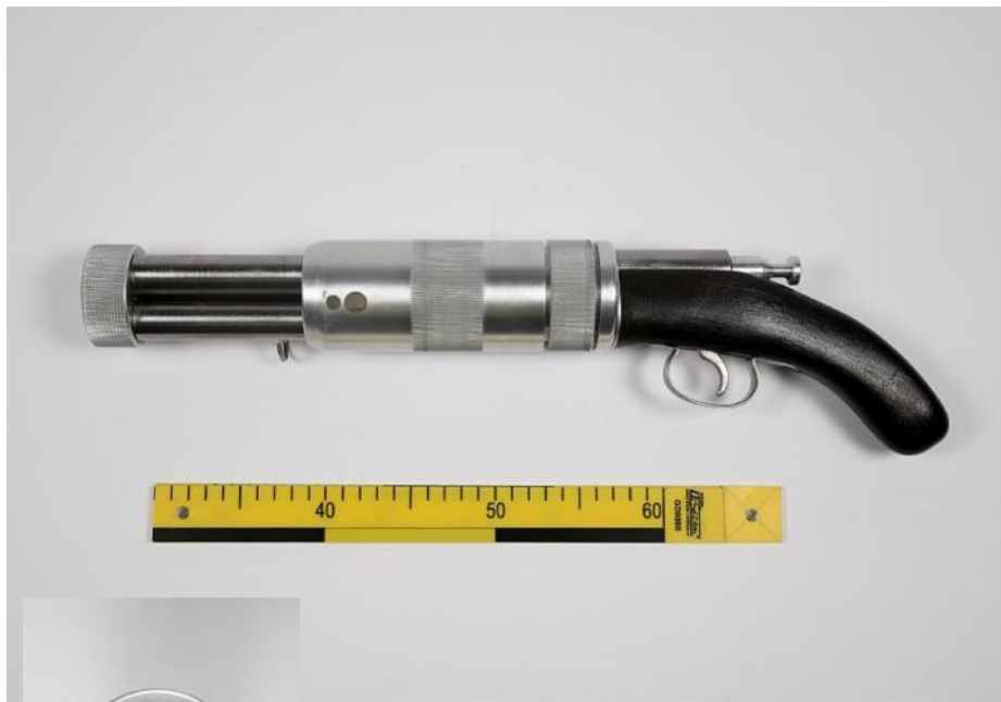
Podomácku vyrobená tříhlavňová brokovnice ráže .20
